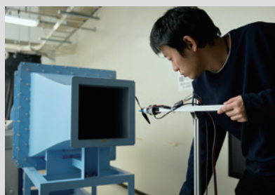
研究室の風洞を使ってロータの空力特性を評価する。無数にパラメータがある小型ロータの形状と性能の関係を精査するため、地道に実験を行いデータを蓄積している。
