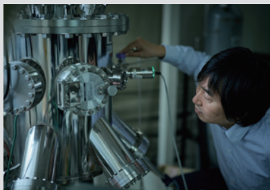
実験室ではハイエントロピー合金の薄膜をプラズマレーザーを使って作製している。
